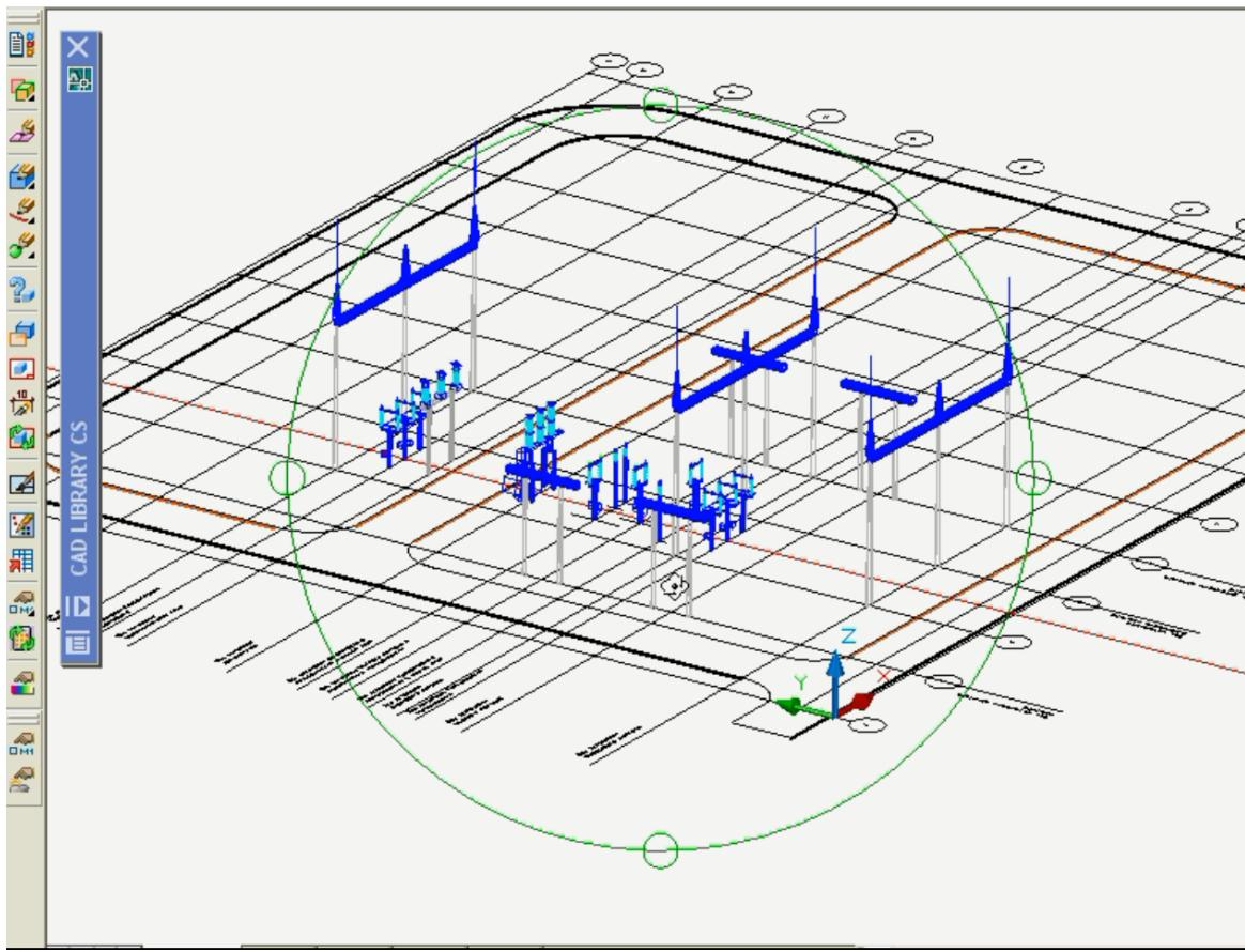
Рис. 60. Полученная двухмерная схема подстанции разворачивается в трехмерную средствами программного комплекса Model Studio CS OPY v.2
