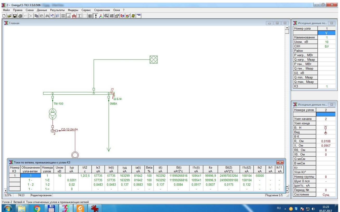
Рис. 26. Результаты расчета КЗ в программном комплексе EnergyCS TK3.
