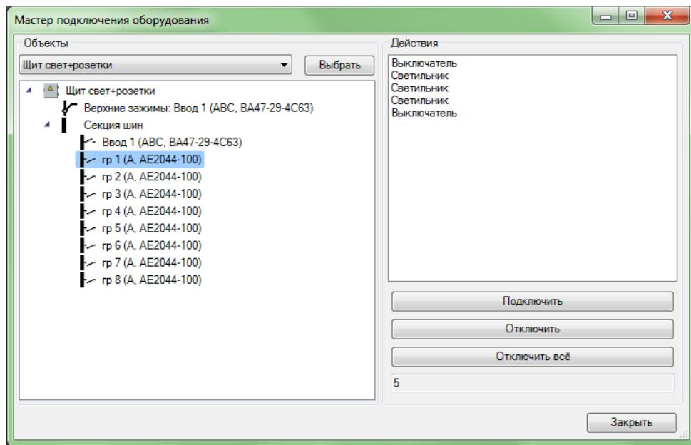
Рис. 150. Подключение каждой комнаты к отдельному автоматическому выключателю
