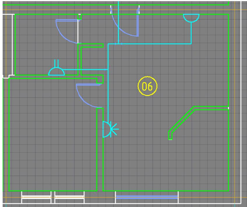
Рис. 143. Установленные розетки в комнате № 06
