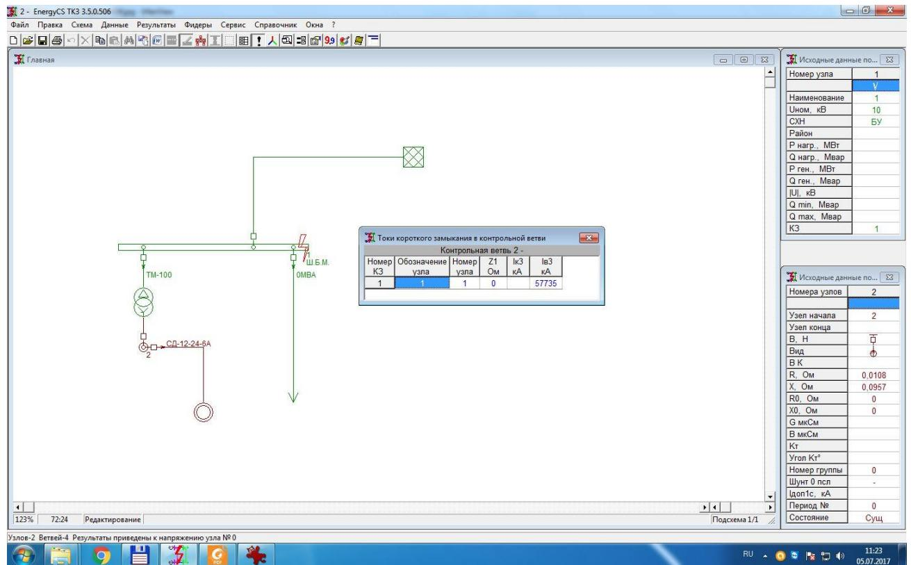
Рис. 27. Результаты расчета кз в программном комплексе EnergyCS ТК3.
