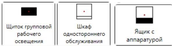
Рис. 148. Тип установленных шкафов и ящика
