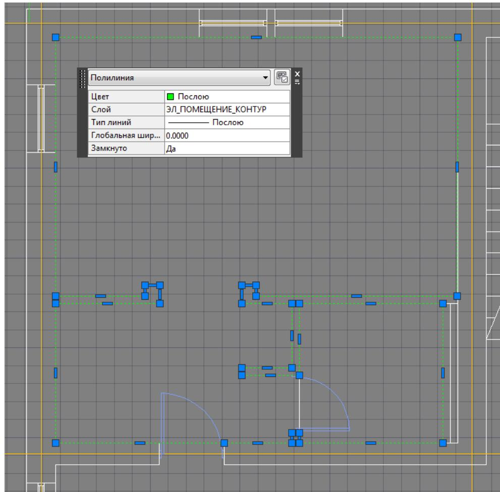
Рис. 117. Определяем границы комнат
