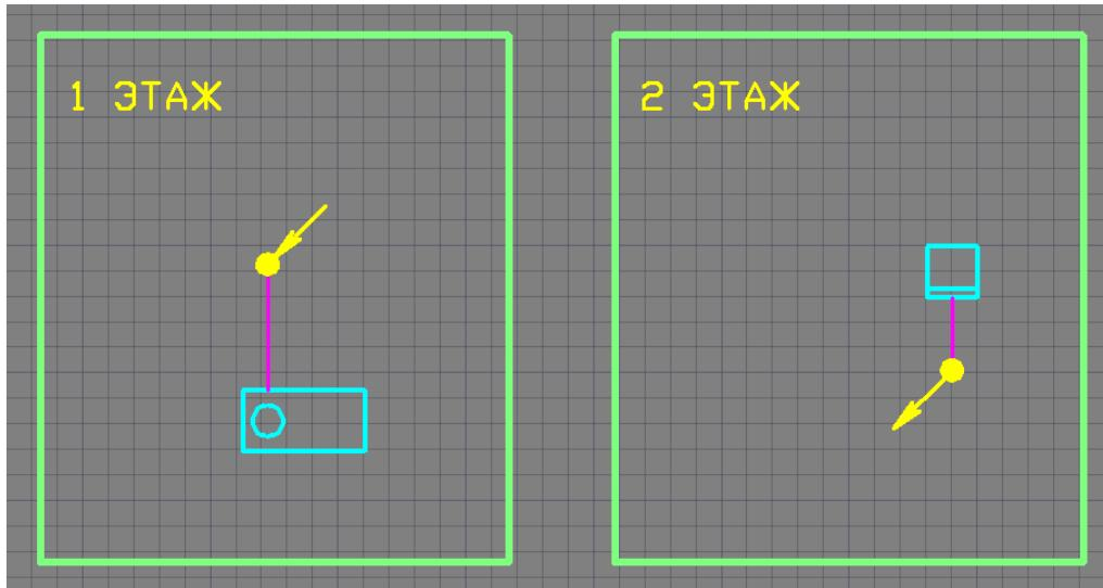
Рис. 104. Пример перехода трассы между этажами
