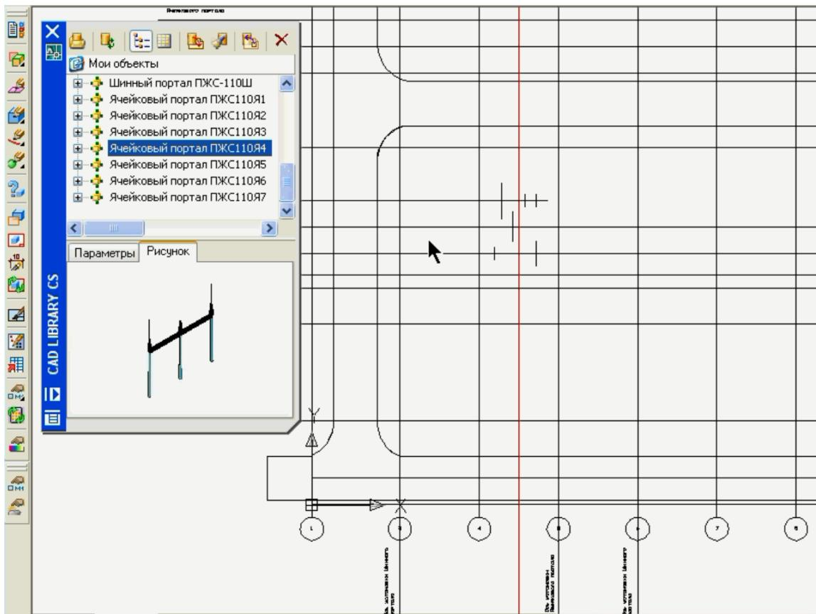
Рис. 56. На введенный план подстанции из библиотеки объектов располагаем нужные элементы электрической схемы в программном комплексе Model Studio CS OPY v.2
