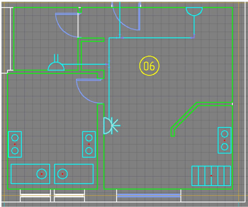
Рис. 146. Вид комнаты № 06 с установленными розетками
