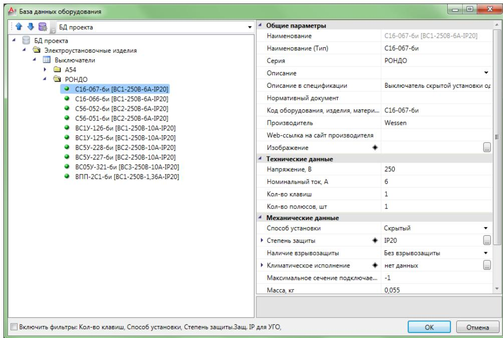
Рис. 133. Выбор выключателя из базы данных оборудования
