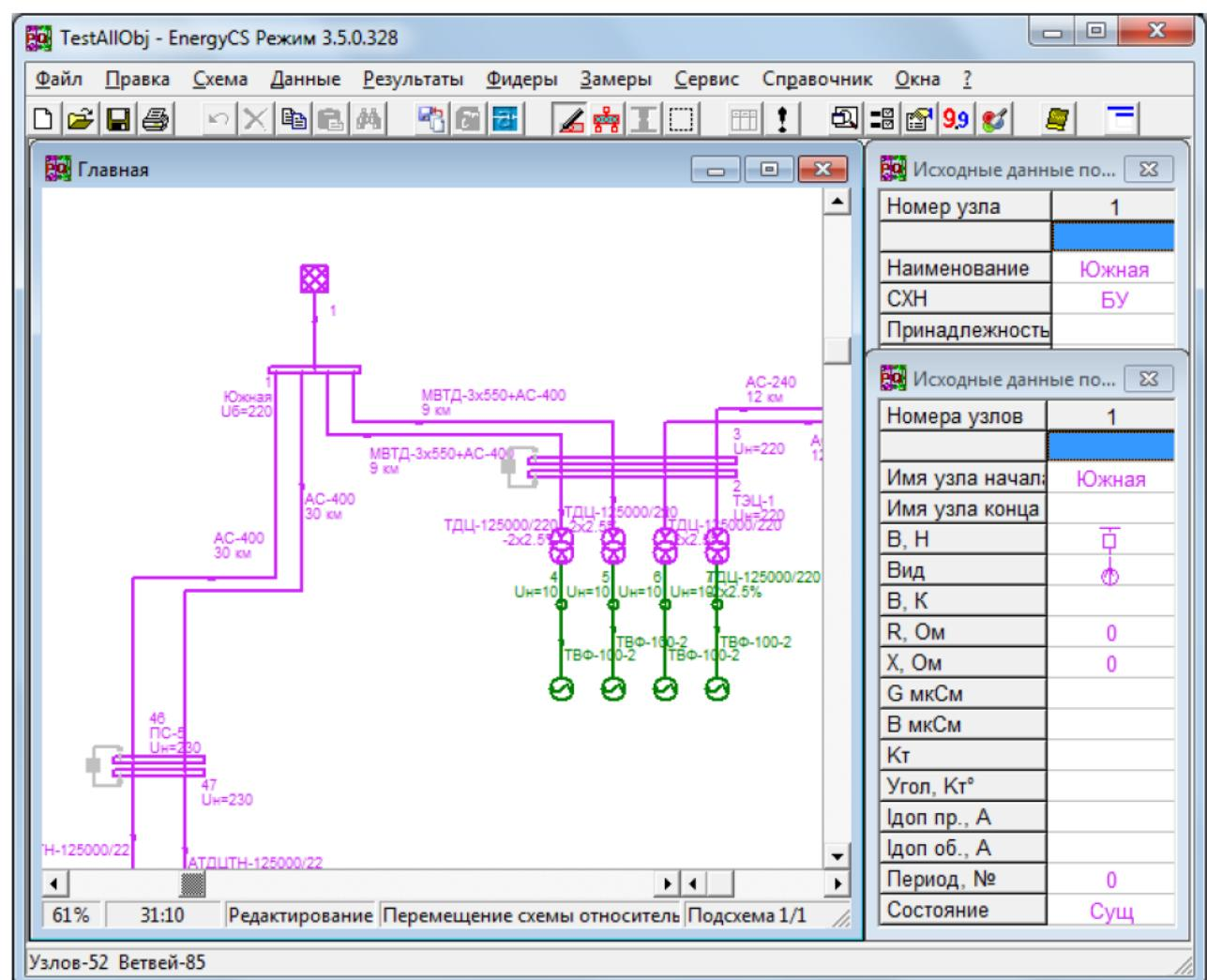
Рис. 14. Вид главного меню и панели инструментов при открытой БДМ.
