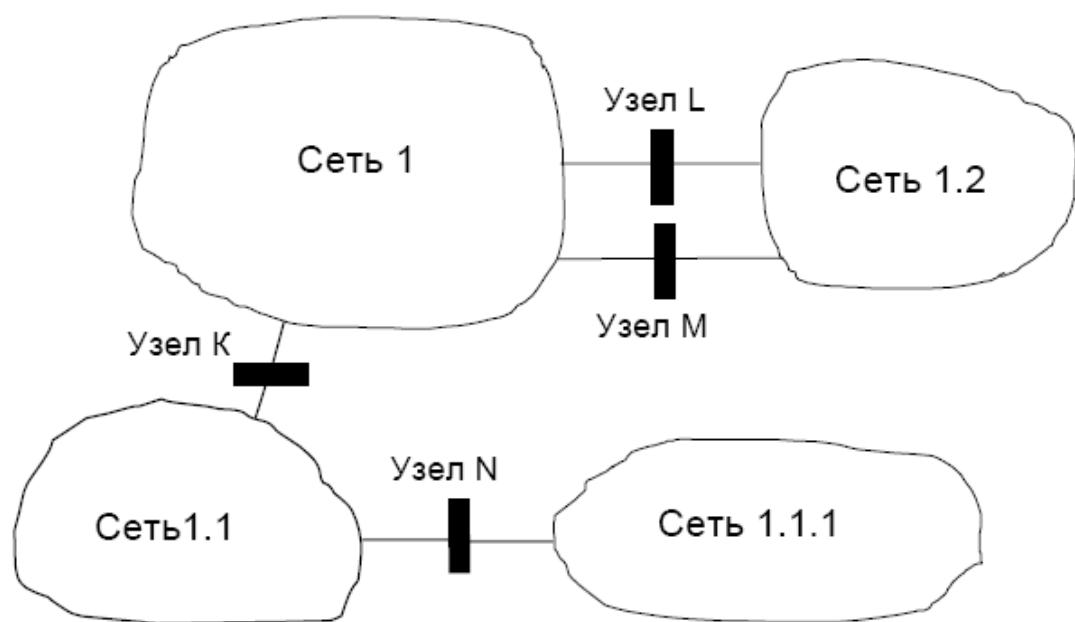
Рис. 10. Пример возможной разбивки электрической сети на подсхемы
