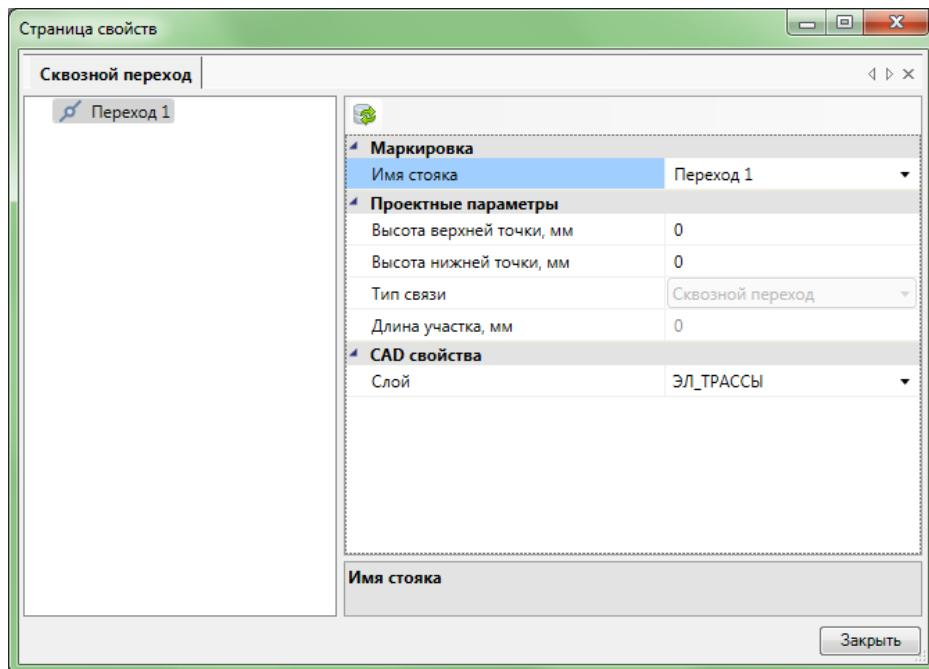
Рис. 103. Окно создания перехода между этажами
