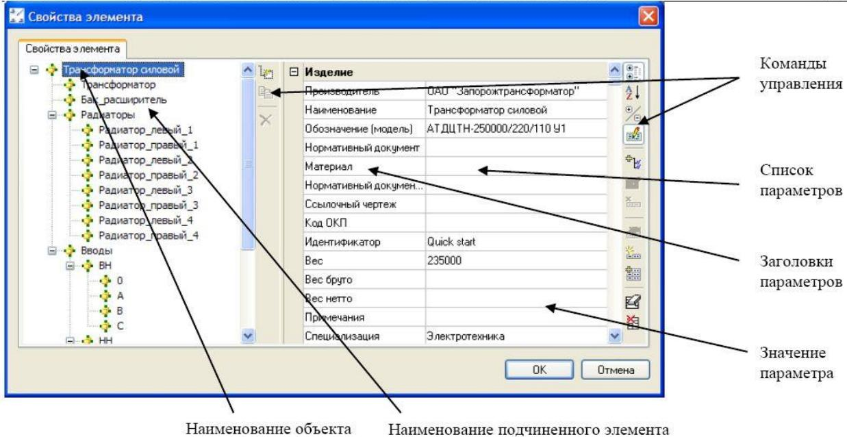
Рис. 64. Иерархия элементов модели
