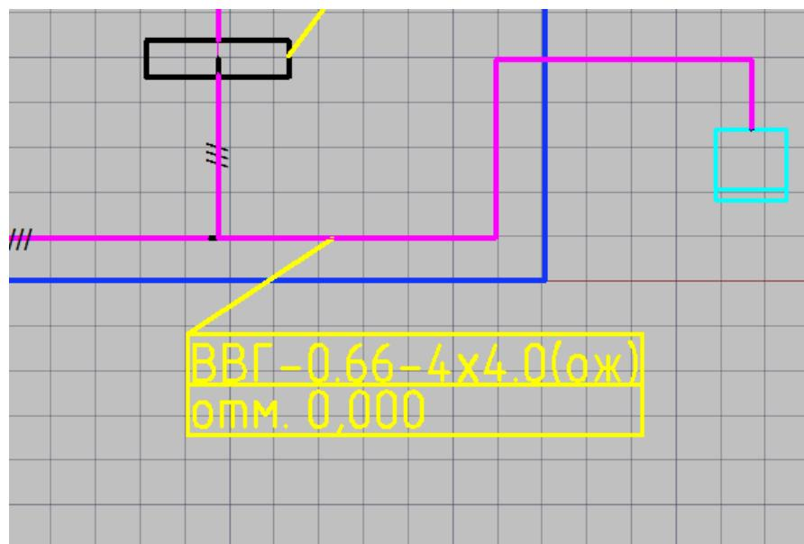
Рис. 107. Пример выноски сечения кабеля
