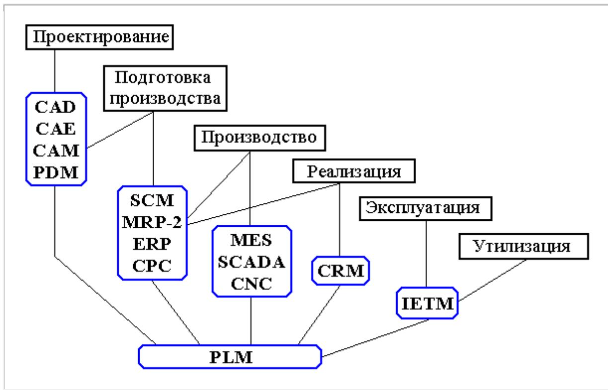
Рис. 4. Основные типы автоматизированных систем
