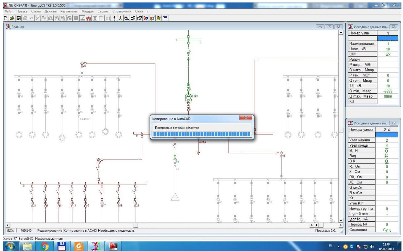
Рис. 21. Передача схемы модели из программного комплекса EnergyCS TK3 v.3. в AutoCAD.
