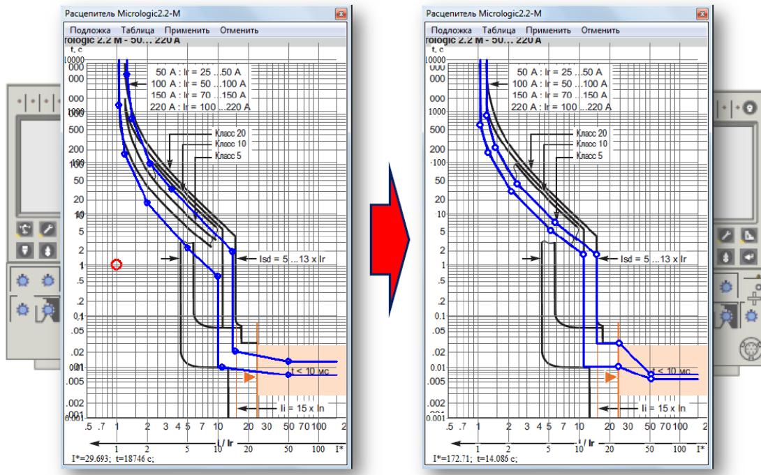
Рис. 50. Пример использования инструмента «подложка»
