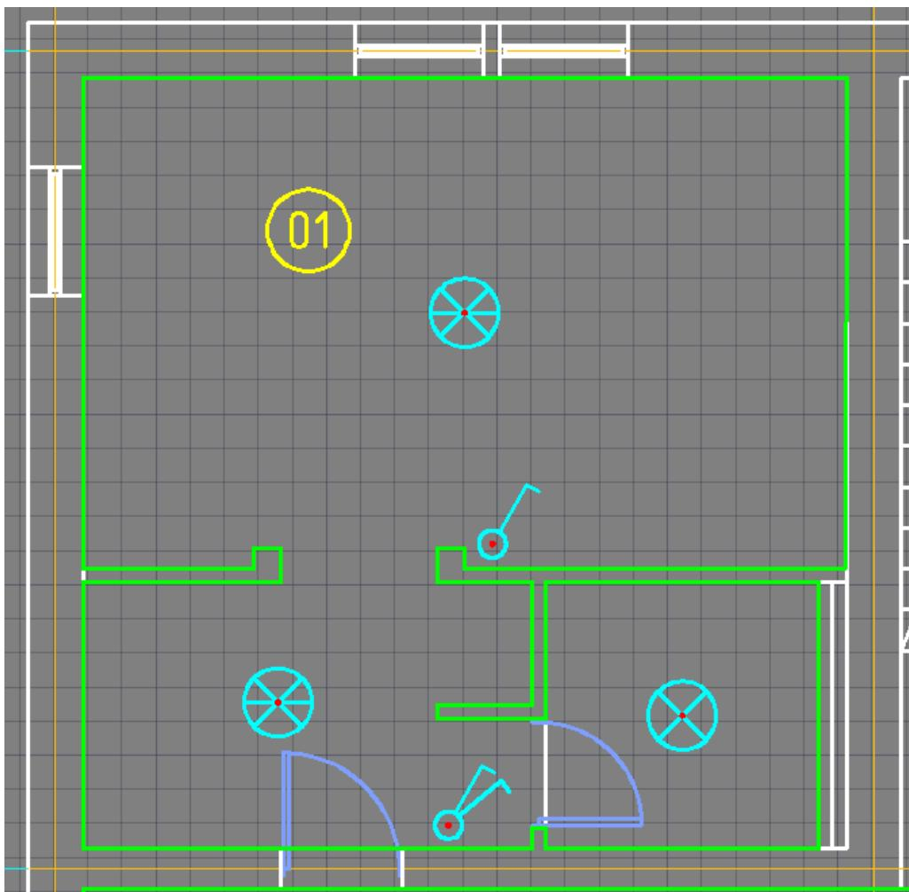
Рис. 132. Вид комнаты с установленными выключателями
