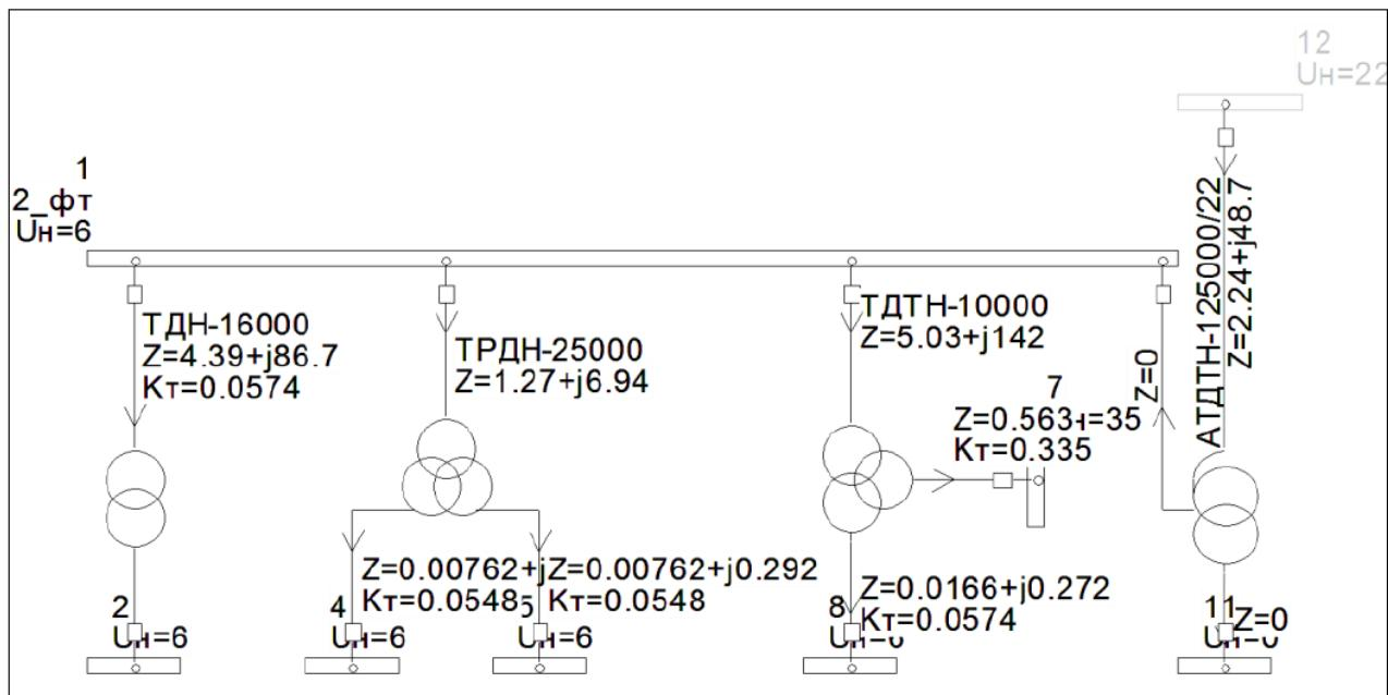
Рис. 16. Примеры изображения двухобмоточных трансформаторов, трансформаторов с расщеплением, трехобмоточных трансформаторов и автотрансформаторов
