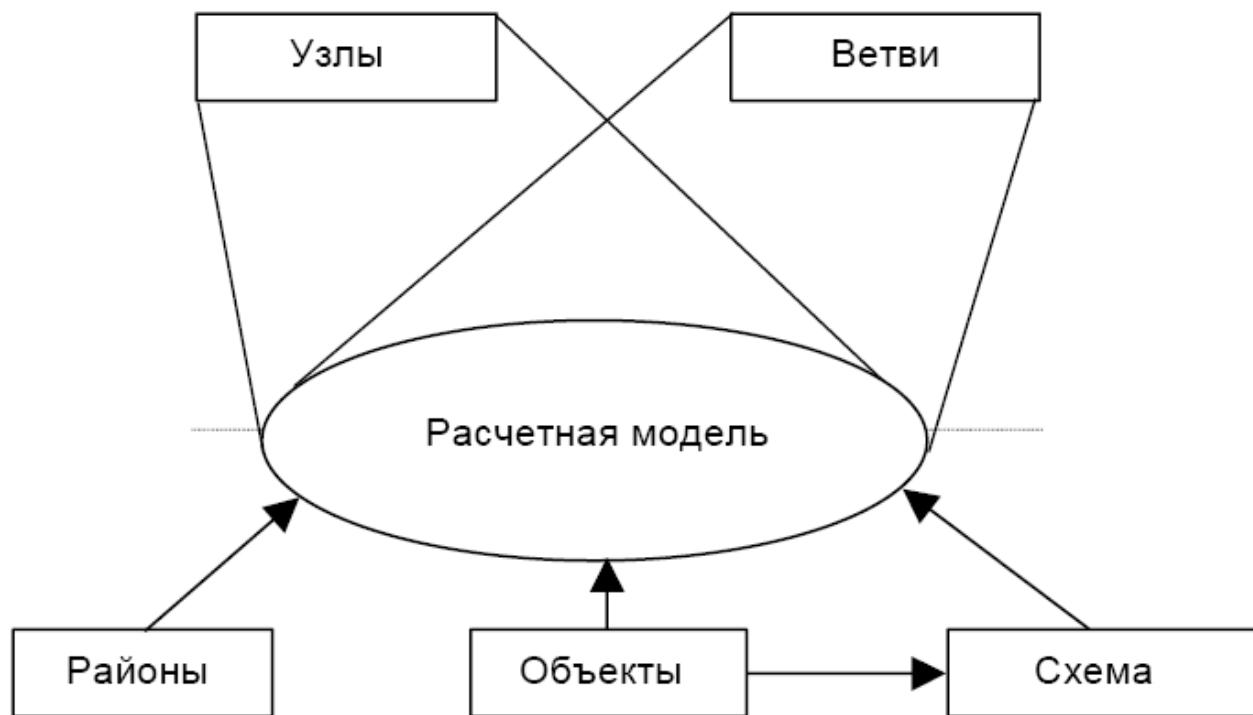
Рис. 12. Структура расчетной модели электрической сети
