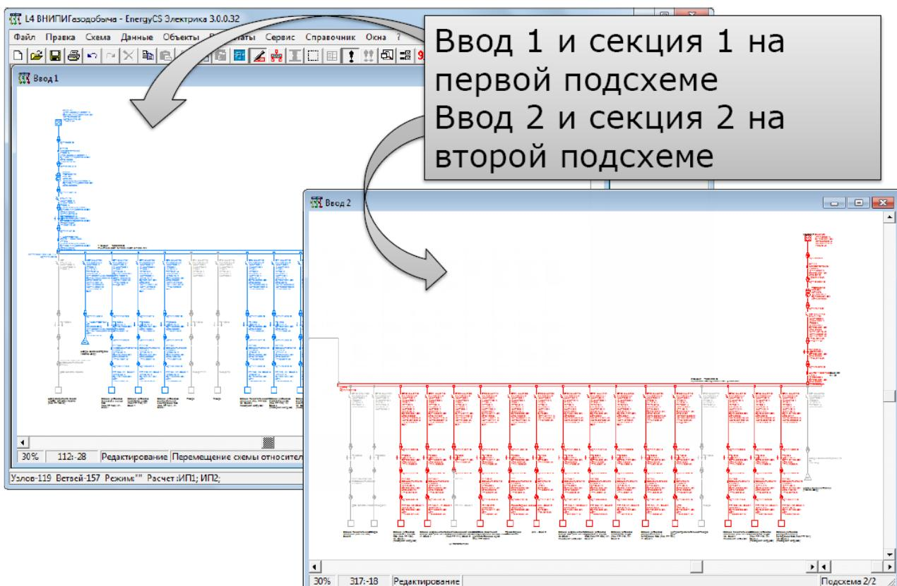
Рис. 42. Пример представления модели на нескольких страницах в программном комплексе EnergyCS Электрика v 3.
