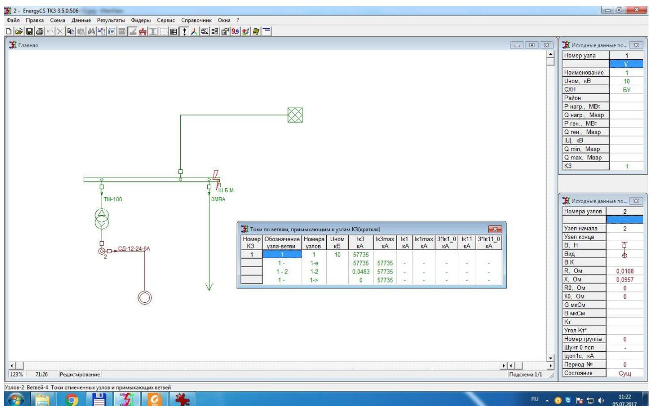
Рис. 28. Результаты расчета кз в программном комплексе EnergyCS ТК3.
