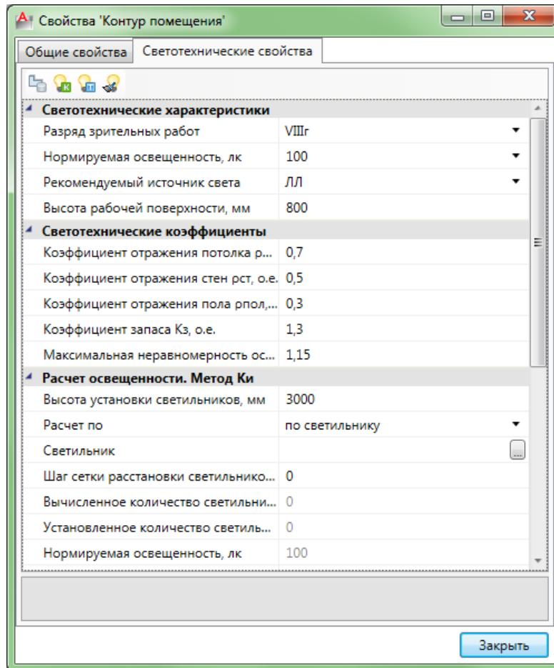
Рис. 89. Светотехнические свойства помещения
