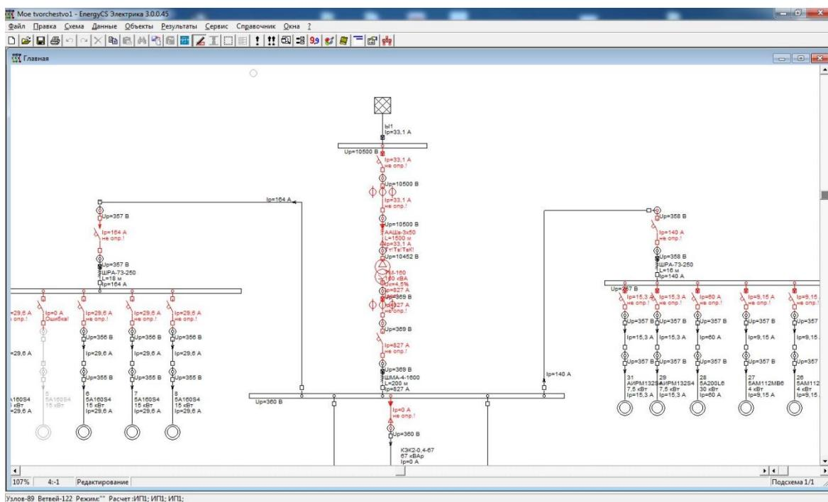
Рис. 31. Пример расчета по представленной схеме (одно нажатие клавиши «расчет») в программном комплексе EnergyCS Электрика v 3.
