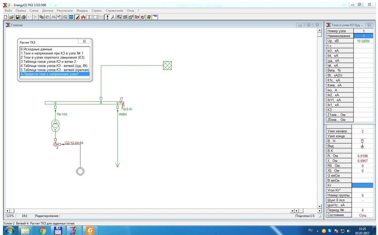
Рис. 25. Пример выбора точки расчета КЗ в программном комплексе EnergyCS TK3.
