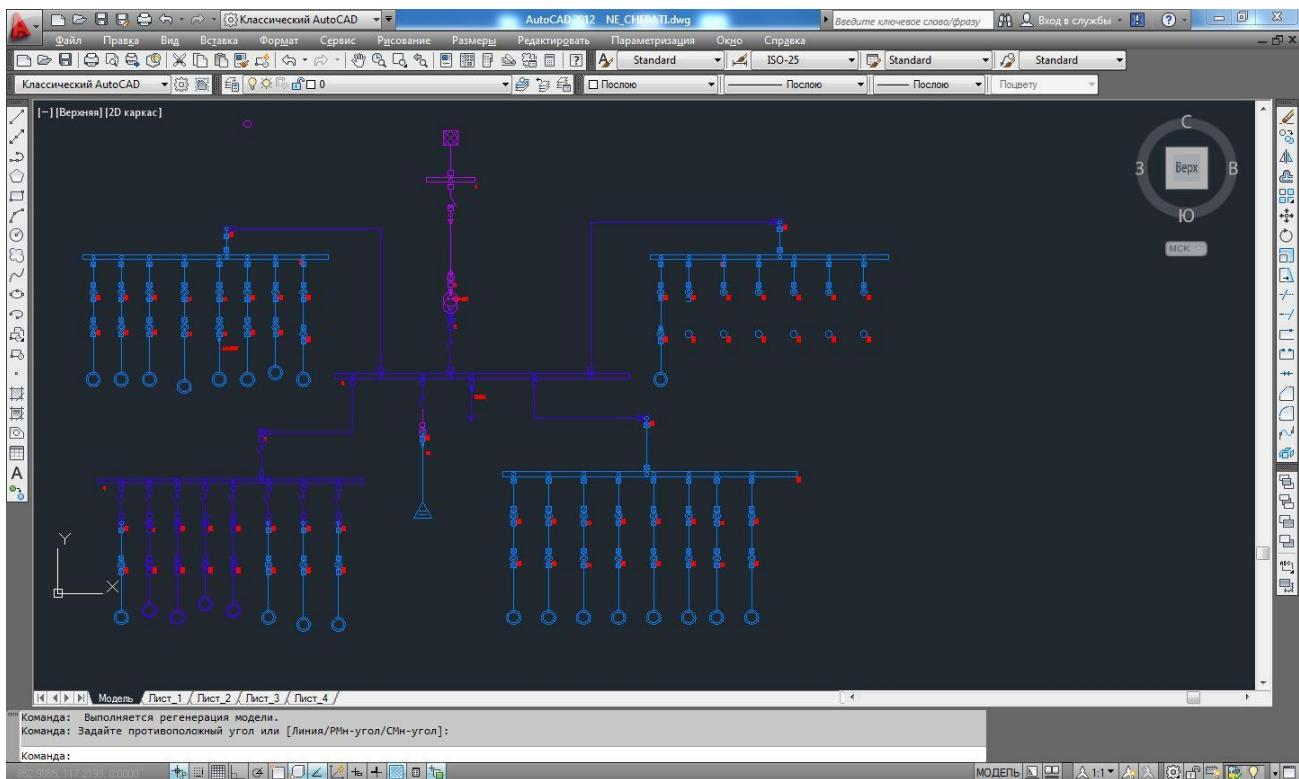
Рис. 22. Представление расчетной модели программного комплекса EnergyCS ТКЗ в AutoCAD.
