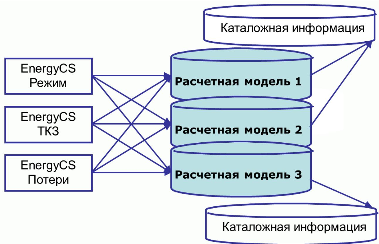
Рис. 6. Отношение между модулями, расчетными моделями и справочником.
