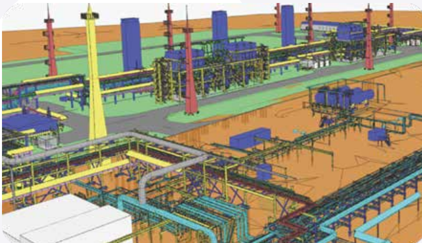
Трехмерная информационная модель дожимной компрессорной станции, выполненная в Model Studio CS и CADLib Модель и Архив
