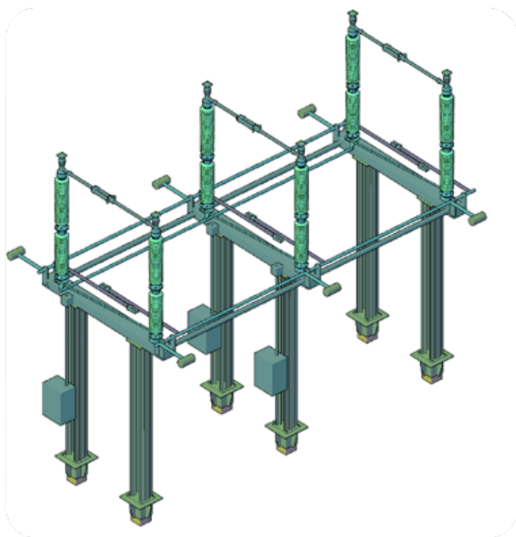
Модель разъединителя РПД922092, созданная в Model Studio CS OPY
